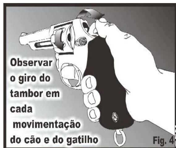
Fig. 4 Verificação do giro do tambor, Ponta do Percussor e Gatilho.
