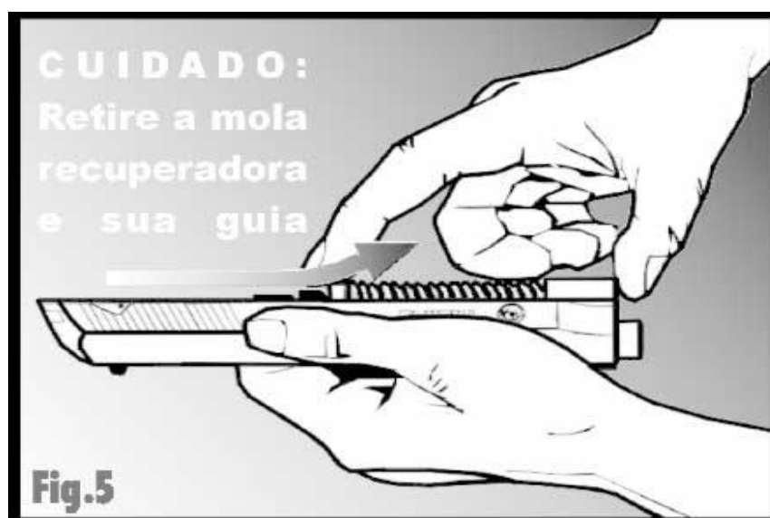
Fig. 5 Mola Recuperadora e Guia
