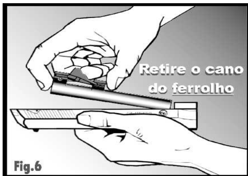
Fig. 6 Cano do Ferrolho
