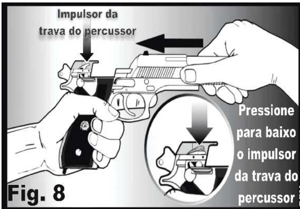
Fig. 8 Impulsor da Trava do Percussor
